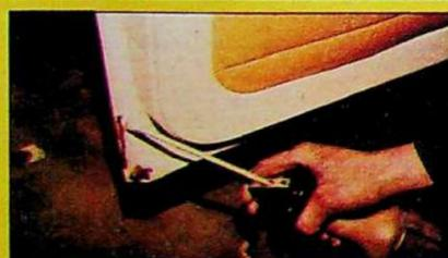
Konservierung des Türrahmens an den Kanten, Auflageflächen und Nietverbindungen. Mit dem Konservierungsmittel mögliche Spalten der Klebeverbindung ausfüllen
