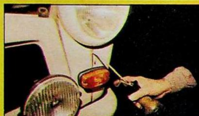
Ausfüllen der Spalten zwischen Kühlerschürzenmittelteil und Duroplastkofflugegel. (Eindringen von Nässe verhindern). Bei Erstkonservierung Blinkleuchte abbauen, um das Eindringen des Elaskongemisches zu gewährleisten.
