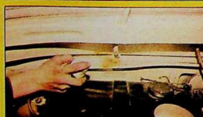
Konservierung der Blechdoppelung und Kante am Windlauf und Wasserablauf mit Korrosionsschutzspray.
