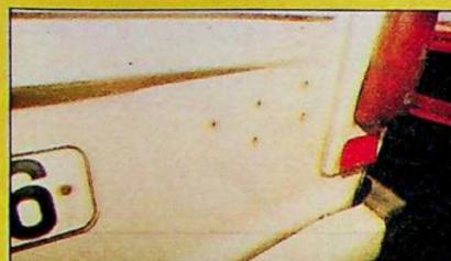
Sich ausbreitende Korrosionsschäden an Bohrlochrandern (Rückwandunterteil; Befestigung der Schriftzüge)
